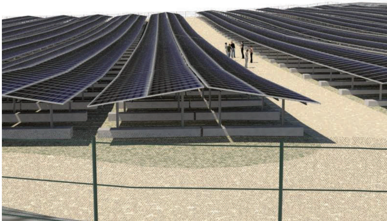
Figure 3 : Principe des structures porteuses des modules photovoltaïques
